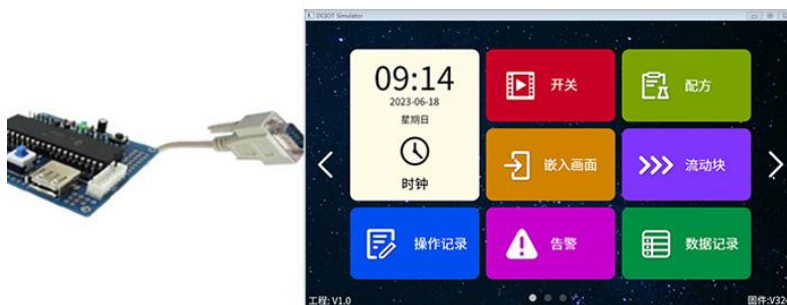
图 6-2 用户单片机串口与“HMI 模拟器”联机调试
